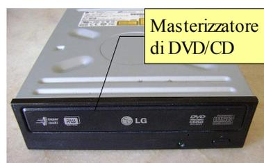
I **dischi ottici** si basano sulla capacità di un sottile strato metallico, generalmente alluminio, di modificare la propria struttura e quindi di riflettere in modo diverso, quando sollecitato da un raggio laser, che serve sia per scrivere che per leggere i dati così memorizzati.
