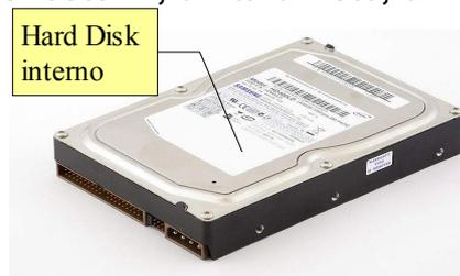
Il **disco rigido** può essere **interno** al computer oppure **esterno**. Nei dischi interni vengono installati il sistema operativo e i programmi e salvati i dati, mentre i dischi esterni generalmente vengono utilizzati per avere una copia di sicurezza dei dati (backup) anche al fine di poterli trasportare; consiste in un contenitore dotato di alimentazione e delle opportune interfacce di collegamento che ospita al suo interno un normale disco rigido.
